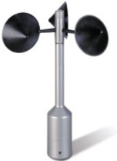
Los anemómetros miden la componente horizontal de la velocidad del viento, que es un parámetro crucial para los sistemas de elección de emplazamiento. Los anemómetros de copa son el tipo de anemómetro estándar. Son robustos y resistentes a turbulencias creadas por la torre y las travesas. Cada anemómetro debe ser calibrado, y debe llevar consigo su certificado de calibración (Por ejemplo, MEASNET). Se requieren al menos tres anemómetros por mástil, y pueden ser equipados con o sin calefacción.
